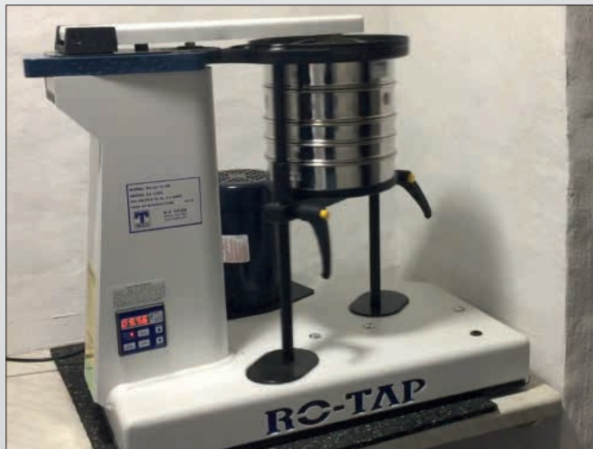
Die „mechanische“ Schüttelbox zur Ermittlung des KPS
